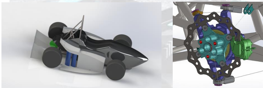
Abb. 3 Fahrzeugverkleidung / Abb. 4 Achsenkel mit Radnabe und Bremse
